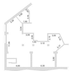
Pianta - Sub 32 - Piano 3S - superficie interna netta mq 141,00 - superficie lorda mq 162,30 - altezza libera m 2,60
